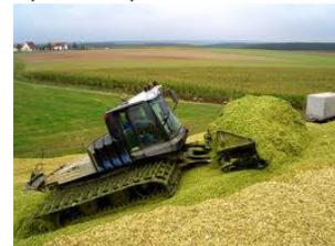
**Pistenraupe** zum Silowalzen, hydr. Klappschild AB 5 m und Siloverteiler AB 2,8 m, Gesamtgewicht 10 t, 360 PS und **LKW** Mercedes Actros 3848, 480 PS, Allradantrieb, 600-er Bereifung, Abschieberaufbau mit Abdeckung, 50 DIN-m<sup>3</sup>, Nutzlast 20 t
